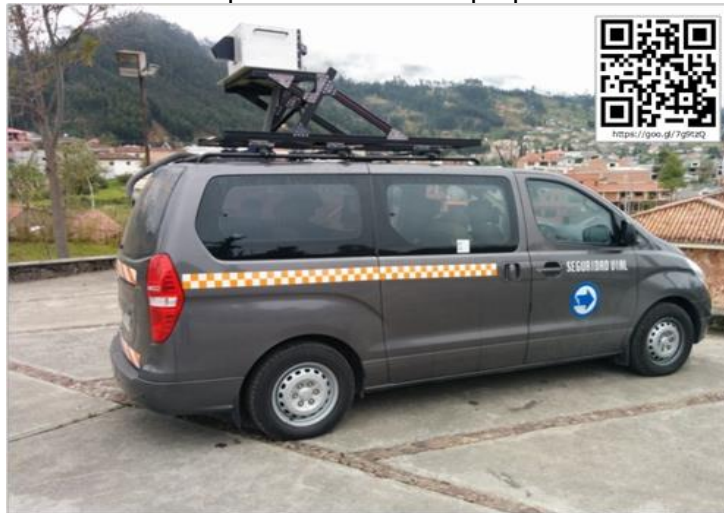
Ilustración 1. Sistema de mapeo móvil MX1 de propiedad de RHV Consultores.
